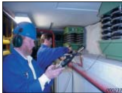
Abb. 3 Anwendung von FFT bei der Untersuchung der Schwingungsisolierung in einem großen Kraftwerk
